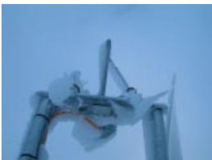
Bild 7 Vereistes Anemometer und Windfahne auf der Gütsch-Anlage.
