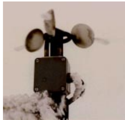
Bild 4 Trotz beheiztem Anemometer konnte sich an den Schalen des Windmessgerätes, welches der Steuerung der Anlage auf dem Grenchenberg dient, Raureif ansetzen, was zu grossen Fehlmessungen führt (Foto ADEV).
