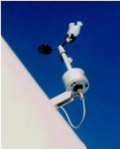
Bild 5 Auch an diesem Anemometer an der Anlage auf dem Gütsch setzte sich Raureif an – trotz geheiztem Instrument. (Foto ADEV).
