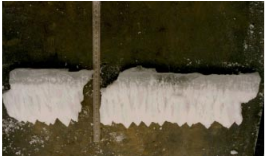
Bild 6 Meist bildet sich in Nebelsituationen Raureif, bei vereisendem Regen kann an den Rotorblättern aber auch klares Eis auftreten, wie hier auf dem Grenchenberg.
