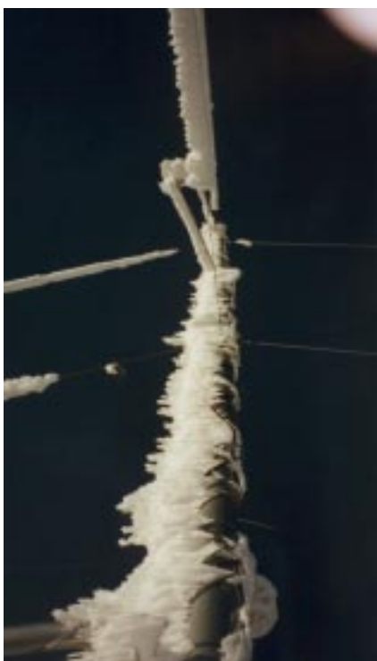
Bild 3 An Standorten mit harschen klimatischen Bedingungen, wie hier auf dem Gotthardpass, sind geheizte Anemometer notwendig (Foto NEK).
