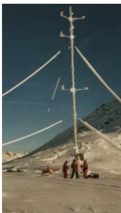
Bild 3 An Standorten mit harschen klimatischen Bedingungen, wie hier auf dem Gotthardpass, sind geheizte Anemometer notwendig (Foto NEK).
